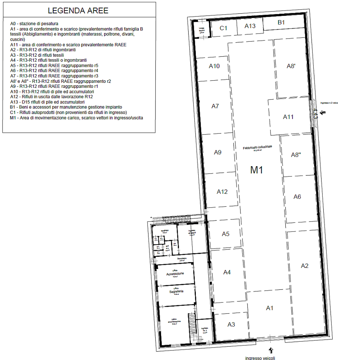
Figura 3: Pianta dello stabilimento in scala 1:400 con l’indicazione delle varie aree rifiuti
